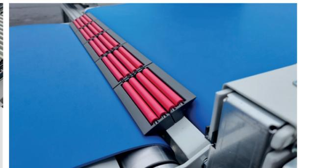
Die angetriebene Gurtkurve GK52-KA kann auch als Einzelkomponente bezogen und in bestehende Förderanlagen nachgerüstet werden.
